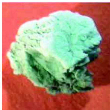
► Rys.1. Mikrokrystaliczny depozyt silnikowy
